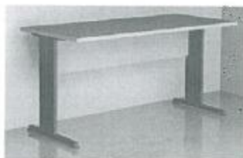
1.18. Читателска маса с размери 600\900\740мм. – 20 бр. С метални страници на регулируеми стълки, прахово боядисани в тъмен цвят. Плот, гръб и полица от 18мм ламинирано ПДЧ. Плот кантиран с 2 мм АБС кант.
