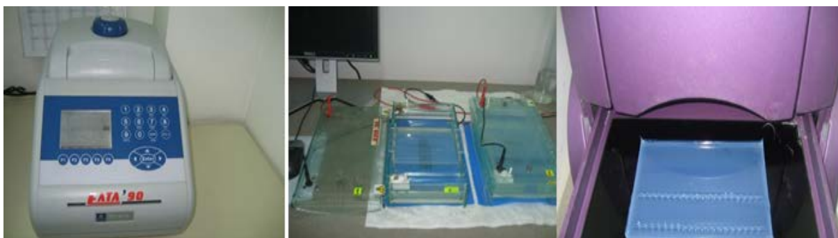
Фиг. 5. PCR апарат Elta'90. Фиг. 6. Вана за хоризонтална агарозна гел-електрофореза; UV-илюминатор за визуализация на продуктите.
