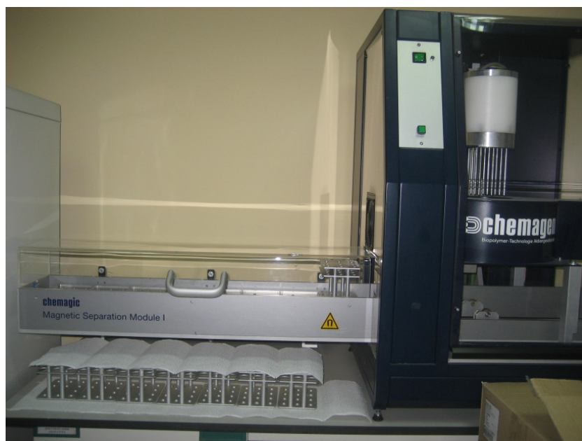
Фиг. 1. Полуавтоматизирана система за сепариране с магнитни частици Chemagic Magnetic Separation Module I (Chemagen).
