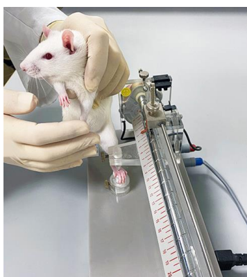
Фигура 1. Метод с прилагане на механично дразнене - Paw pressure test
