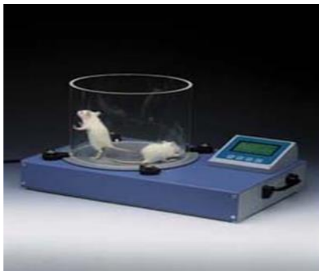
Фигура 2. Метод с прилагане на термично дразнене - Hot plate тест
